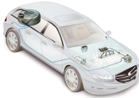
I sistemi ad iniezione sequenziale per mezzo del "riduttore" riducono la pressione del gas a valori adatti all'alimentazione motore (nel caso del GPL dopo averlo trasformato da fase liquida a fase gassosa) e iniettano l'esatto quantitativo di gas nel collettore di aspirazione del motore attraverso l'uso di iniettori elettromeccanici, la cui attuazione è fasata alla rotazione motore attraverso opportuni comandi che provengono da una centralina elettronica di controllo.
