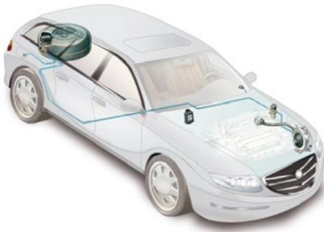
I sistemi di alimentazione con miscelatore per mezzo del "riduttore" riducono la pressione del gas a valori adatti all'alimentazione motore (nel caso del GPL dopo averlo trasformato da fase liquida a fase gassosa) e attraverso il "miscelatore", posto sul condotto di aspirazione, sfruttando l'effetto Venturi, garantiscono una corretta miscelazione aria/gas e ne dosano il flusso proporzionalmente alla richiesta del motore.
